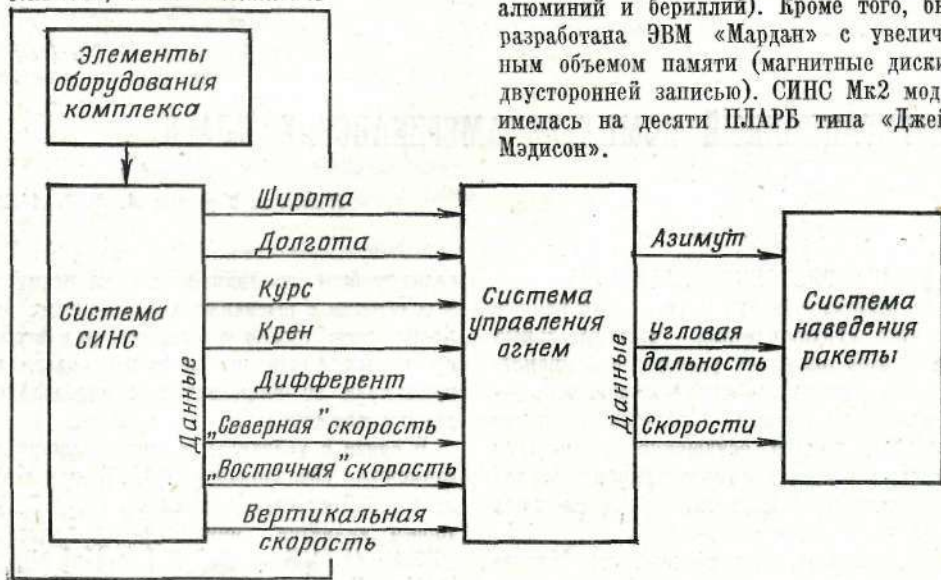
Рис. 1. Функциональная схема навигационного комплекса ПЛАРБ
